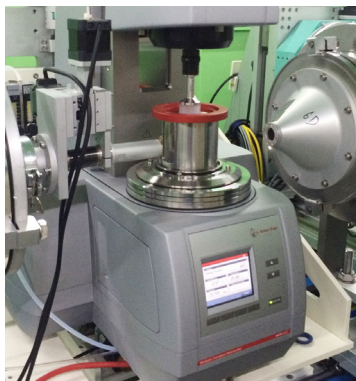
그림 11. PLS-II SAXS 빔라인의 in-situ Rheo-SAXS 장치.
